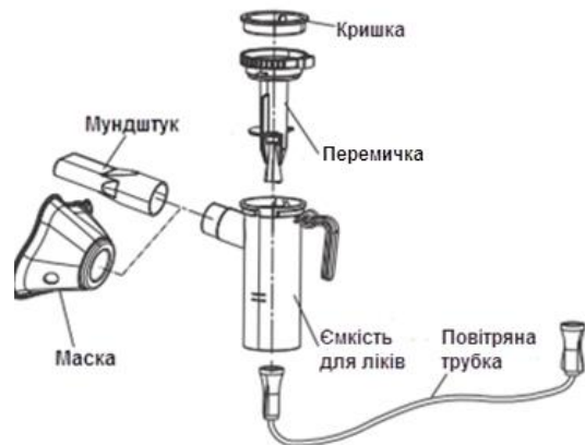
Малюнок 4: Структурна схема комплектуючих і аксесуарів небулайзера
